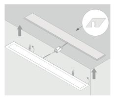
Faça o corte no forro, utilizando as dimensões de corte 130mm x 1200mm. Cuidado para não utilizar a medida externa do produto por engano.
